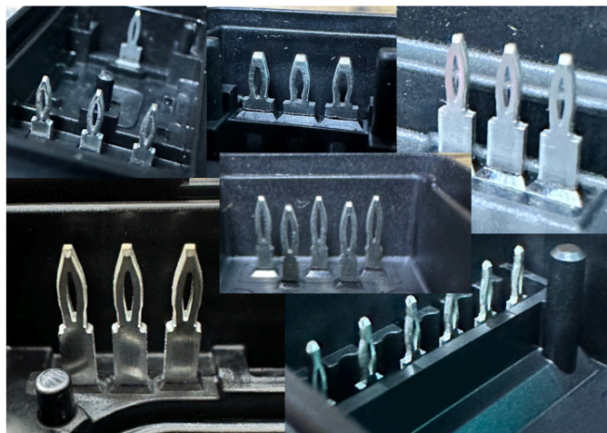
图 11: 蔚莱在制的弹性鹰眼针在汽车零部件的应用
